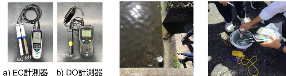
a) EC計測器 b) DO計測器
